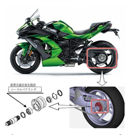
リヤホイールのニードルベアリングにおいて、グリース塗布作業が不適切なためグ リース量が少ないものがある。そのため、ニードルベアリングが潤滑不良となり破 損し、最悪の場合、リヤホイールがロックし走行不能となるおそれがある。
