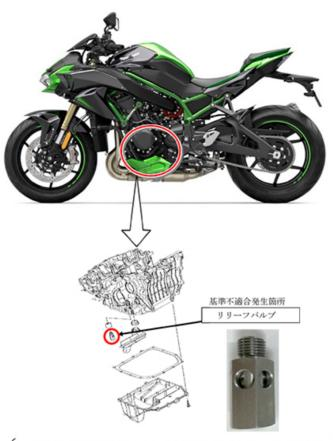
エンジンの油圧を調整するリリーフバルブにおいて、組立作業が不適切なため、 リリーフバルブの構成部品が脱落し、エンジンの油圧が低下する場合がある。そ のため、油圧警告灯が点灯するとともにエンジンが潤滑不良となり、最悪の場 合、エンジンが停止するおそれがある。
