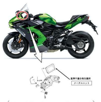
速度計 (メータユニット) において、制御プログラムが不適切なため、走行中に 再起動するおそれがある。そのため、再起動中は運転者が速度等運転に必要な情 報を確認できなくなる。
