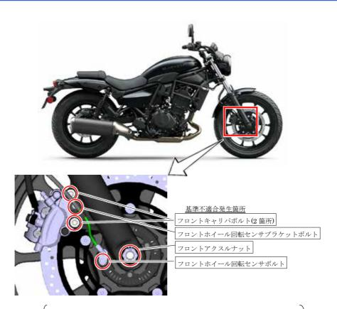
フロントホイール周りの組立工程において、工程管理が不適切であった為、特定のボルト・ナットの締め付けトルクが不足している可能性がある。そのため、走行振動等で当該ボルト・ナットが緩み、異音の発生、走行安定性の低下、制動力の低下等が発生するおそれがある。
